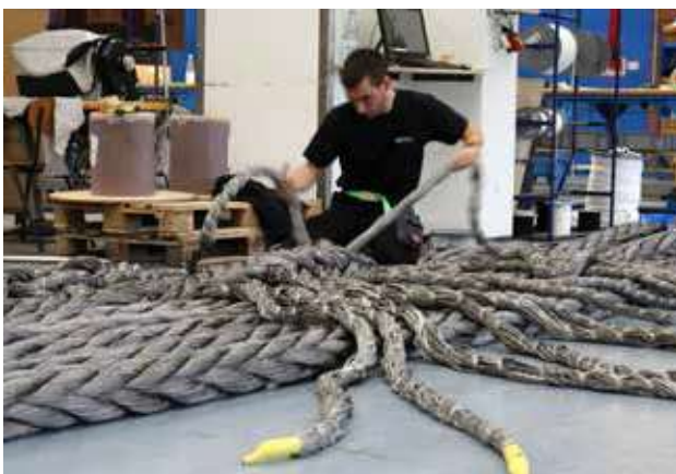
Da geht noch mehr: Sonderanfertigung einer Megaschlinge mit 900 t WLL
